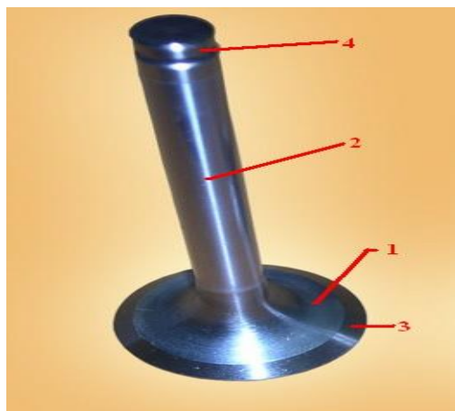
1-taler, 2-tijă, 3-fațetă de așezare pe scaun, 4- locaș de fixare.
