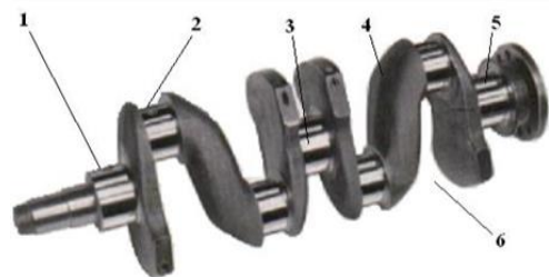
1-Capătul liber 2- fus maneton 3-fus palier 4- braț maneton 5- fus
